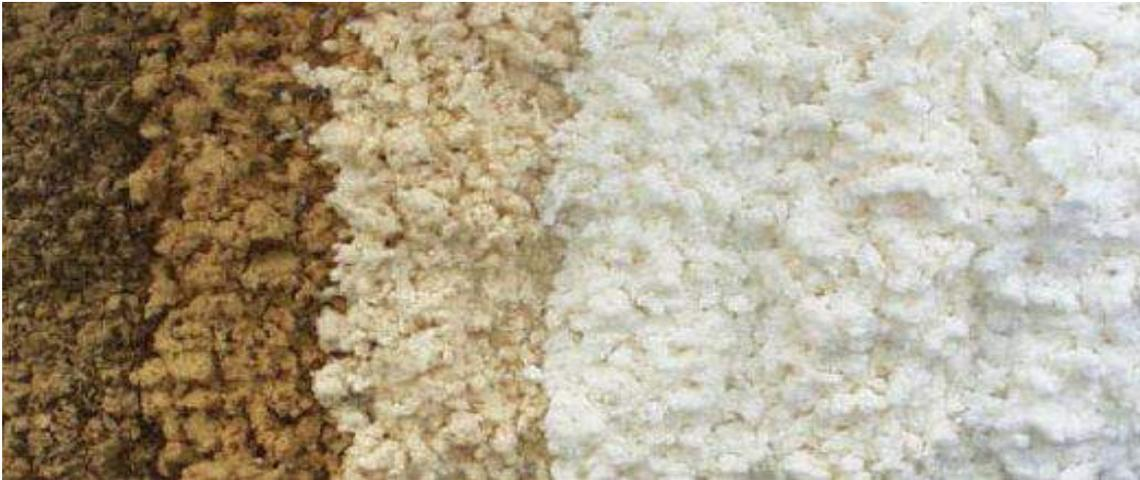
الشكل رقم 3.2: صورة لللب الورق قبل التشكيل.
