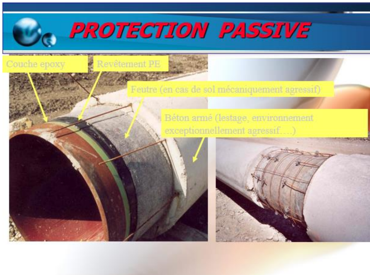
Figure V.3 : Les couches composantes de l'enrobage des conduites en acier [7].
