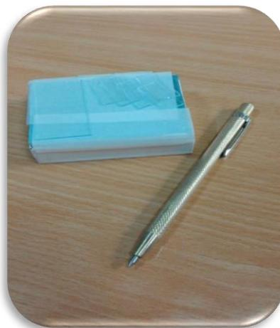
**Figure II.9:**Substrats en verre et stylo à pointe de diamant
