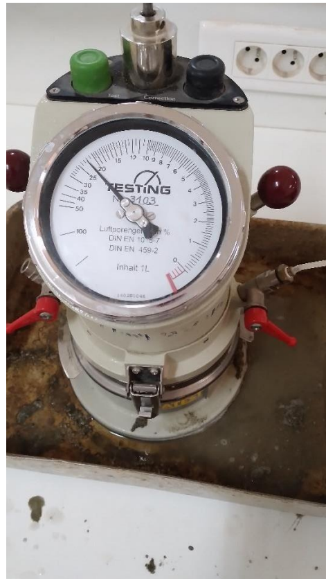
Figure II.16 : mesure de la teneur en air du béton
