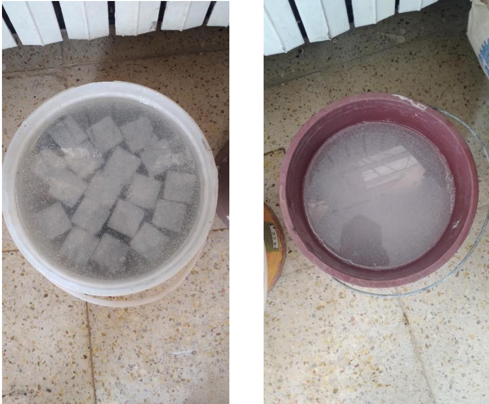
Figure II.13 : les éprouvettes dans la chaux
