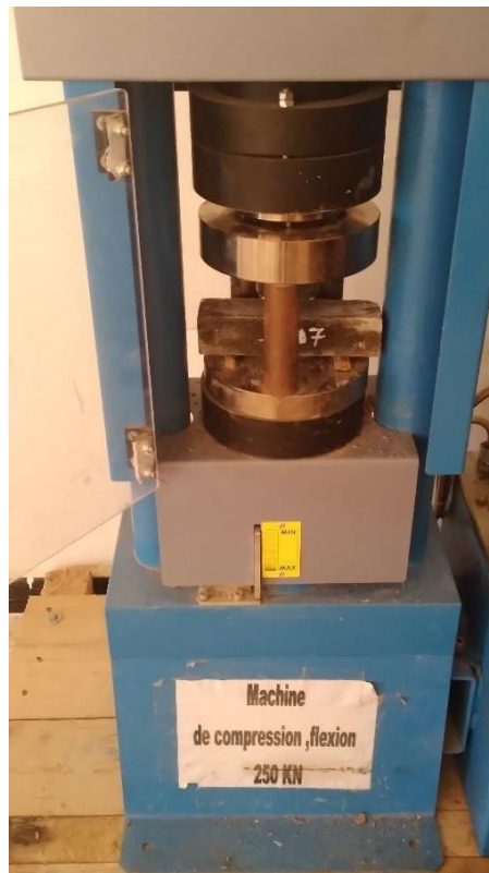
Figure II. 15 : Dispositif pour l'essai de résistance en compression.
