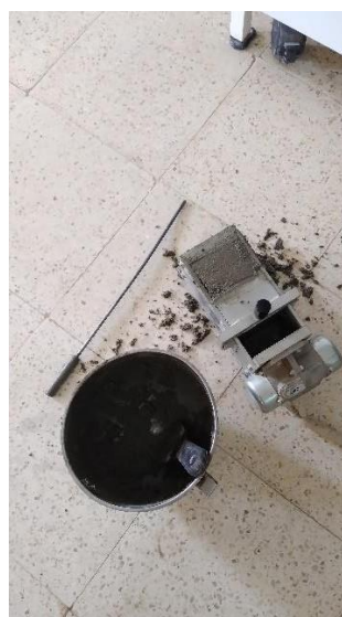
Figure II.10 : Maniabilimètre de mortier.
