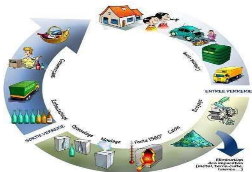
Figure I.6: Processus de transformation de déchets de verre.[12]
