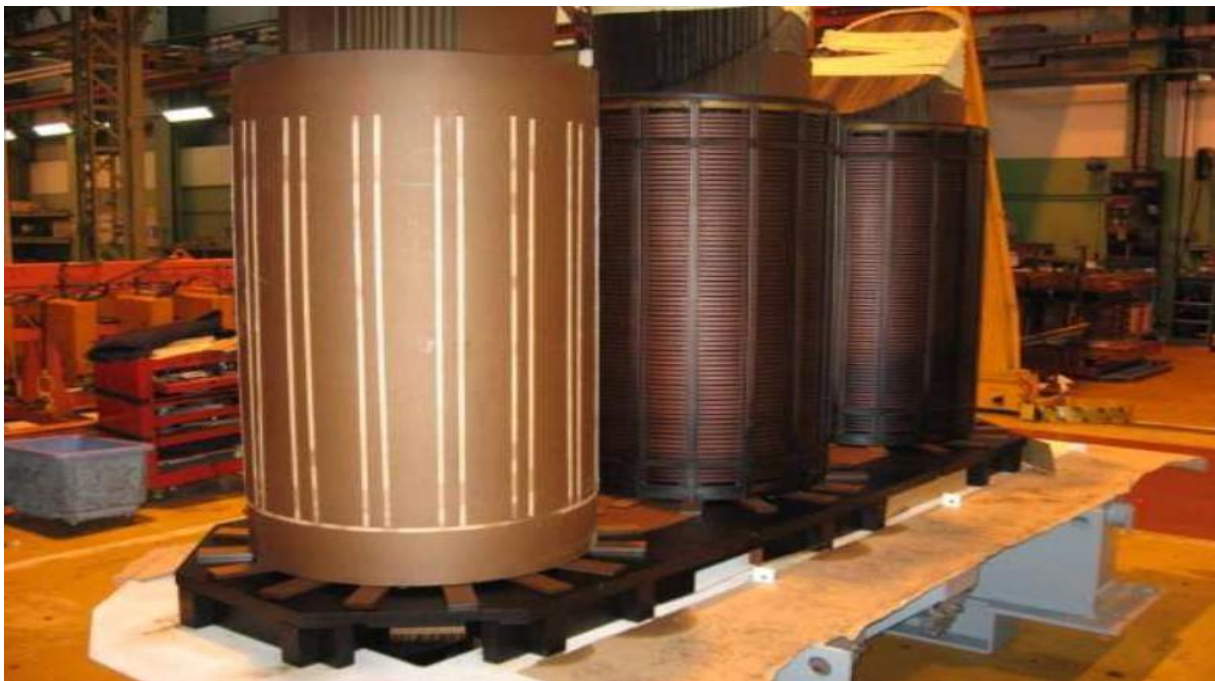
Figure I.8. Enroulement des conducteurs en cuivre pour un transformateur.
