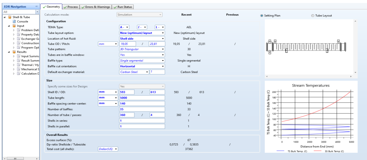
Figure. III.4 Géométrie et type de l'échangeurs simulé sur HYSYS
