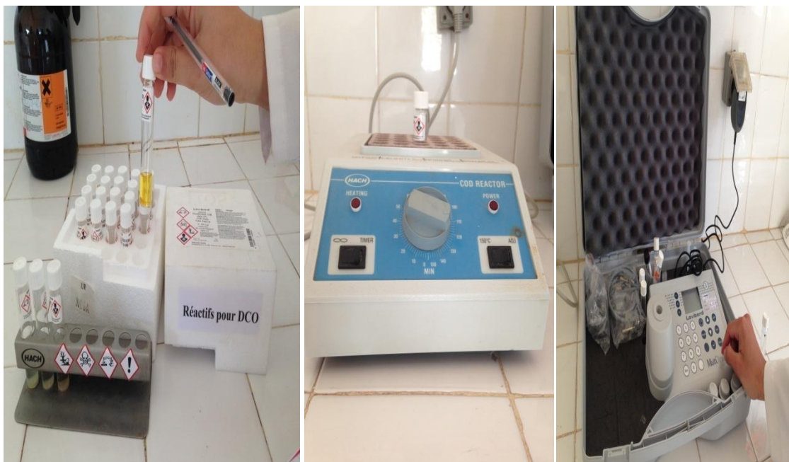
Figure 9 : Réactifs pour DCO / DCO Réacteur / Spectrophotomètre.
