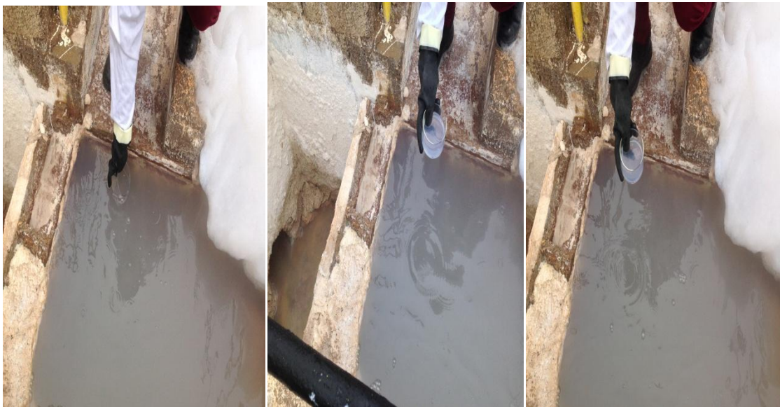
Figure 1: Prélèvement à l'entrée de la STEP
