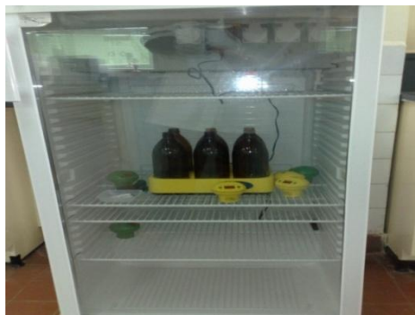
Figure 11 : Armoire thermostatique (T° à 20 °C)
