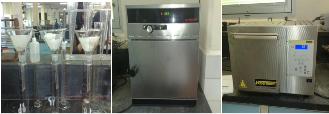
Figure 7: Filtration / étuve à 105°C / four à 600°C
