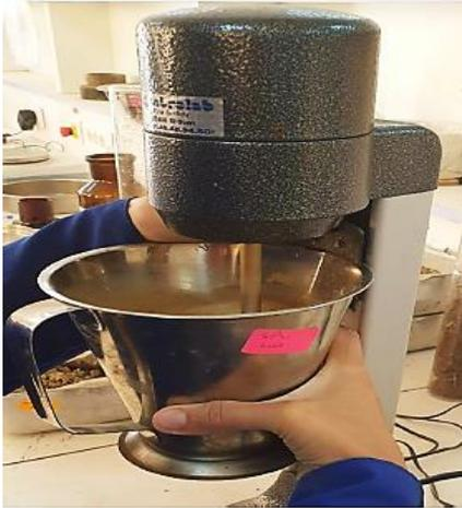
**Figure 16** : Agitation de sol mécaniquement.
