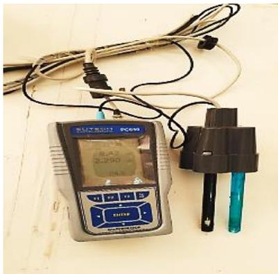
**Figure 21** : Appareil de la mesure de la salinité
