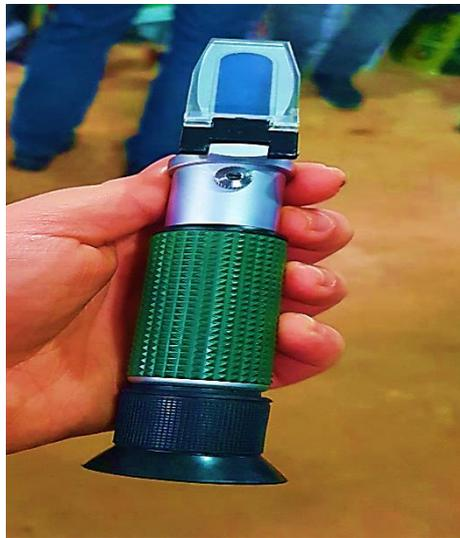
**Figure 23 :** Réfractomètre échelle brix
