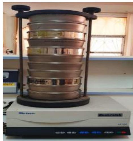
**Figure 15** : Des tamis placé sur vibreur
