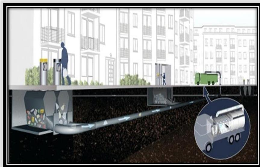
Figure V-10:Schéma de collecte pneumatique.
