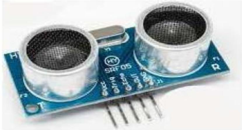
**Figure II.2 :** capteur ultrason. [9]
