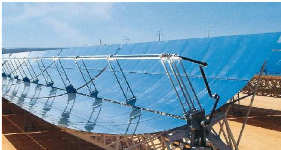
**Figure III- 9:** Capteur cylindro-parabolique. [41]
