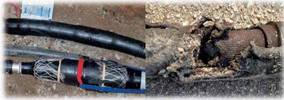
Figure II.1 : Câble défectueux en raison d'un court-circuit [8].
