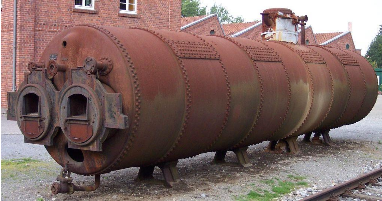
Figure II.1: Une chaudière à vapeur pour moteur stationnaire [14]
