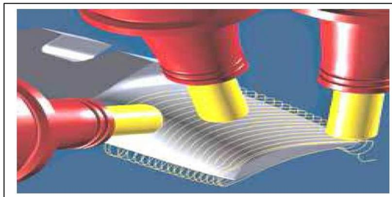
Figure I.19 : Usinage en bout d'aube de turbine 5 axes. [18]
