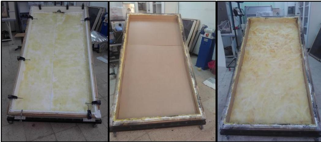
**Figure V.4** : Photos du capteur solaire en cours de fabrication.
