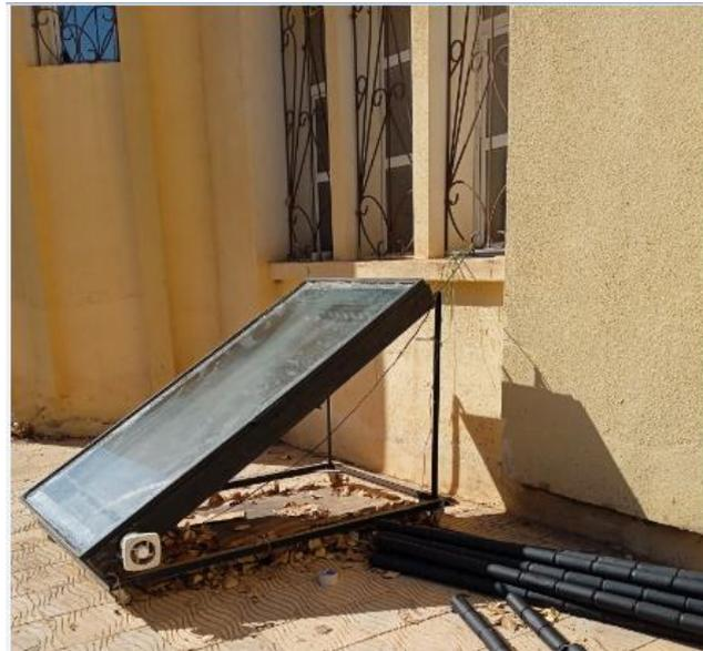
**Figure V .3 :** Collecteur solaire muni d'un absorbeur à cannettes ailletées.
