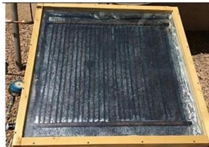
**Figure I.17** :Capteur non vitre[21].
