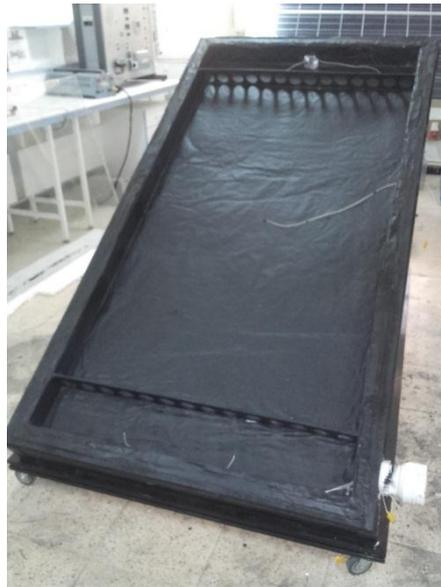
**Figure V .5 :** Capteur solaire sans vitre l'absorbeur.
