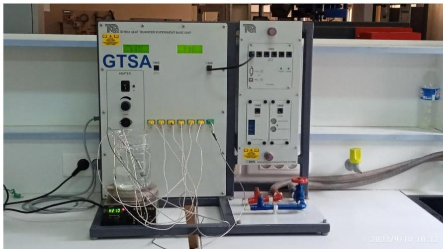
**Figure V.9** : Etalonnage de thermocouples type K.
