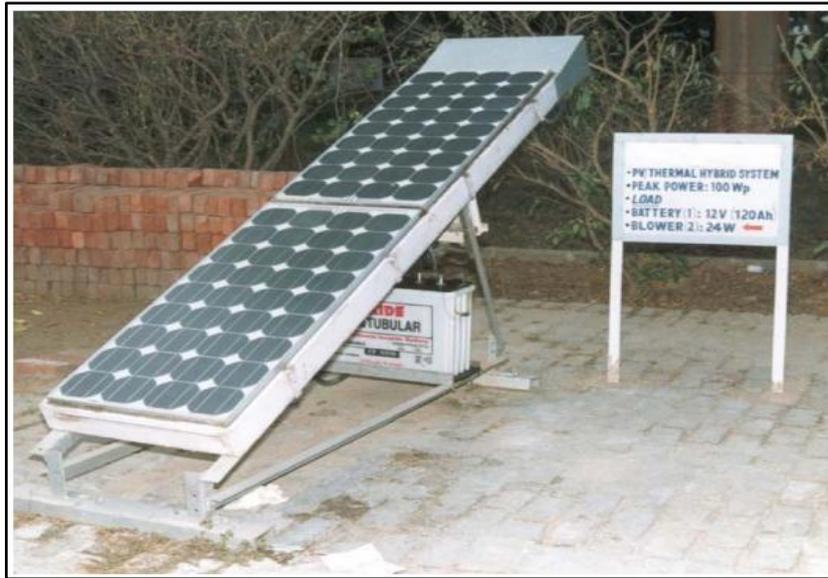
**Figure II.28 :** Banc d'essai de capteur solaire hybride PV/T[54].
