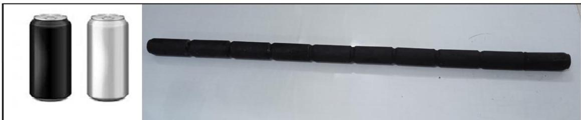
**Figure V .2 :** Rassemblement de canette pour former une conduite cylindrique à ailette.
