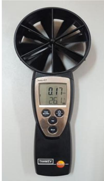
**Figure V.8** : Anémomètre multifonction.
