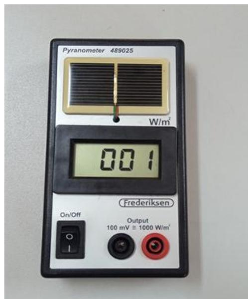
Figure V .7 : Solarimètre.
