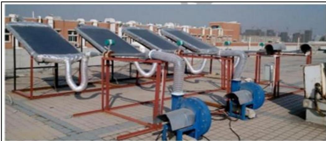
**Figure II.8 :** Quatre types de capteur solaires étudié par Shuilian Li [34].
