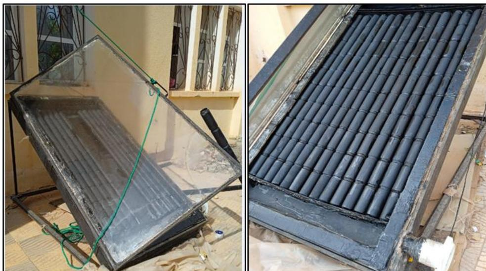
**Figure V .6 :** Emplacements du cadre et les cannettes au niveau de l'absorbeur du capteur.
