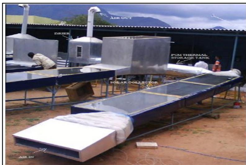
**Figure II.26 :** Capteur solaire à MCP [52].
