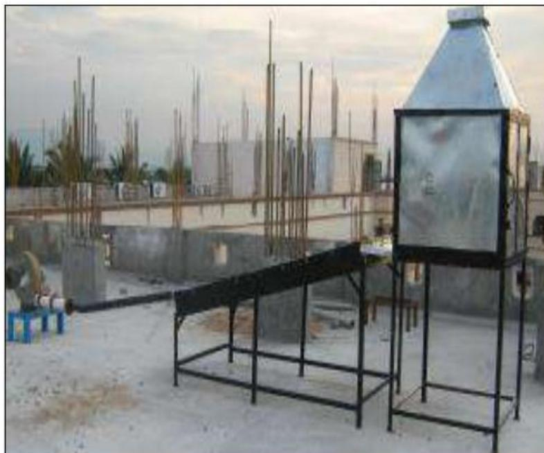
**Figure II.24 :** Dispositif expérimental d'un séchoir solaire[50].
