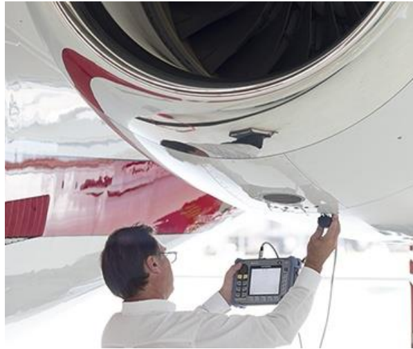
Figure 30 : Contrôle par ultrason du fuselage d'un avion 10
