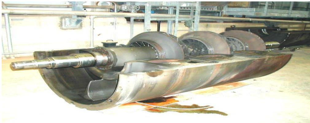
Figure4.A. Rotor d'un compresseur BCL603 (Sonatrach hassi Rmel)
