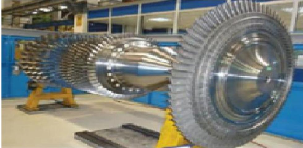
Figure3.A. Rotor d'un compresseur haute pression
