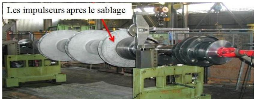
fig 6.16 Rotor avec ses impulseurs sur la machine a équilibrer H6V.
