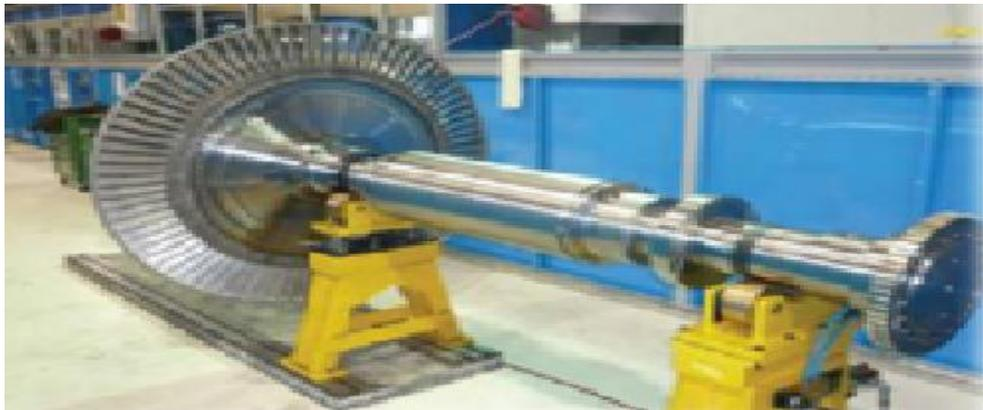
Figure 2.A.Rotor d'un compresseur basse pression
