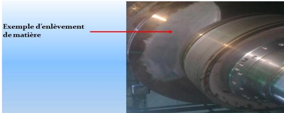
fig 6.17 Enlèvement de la matière sur un impulseur
