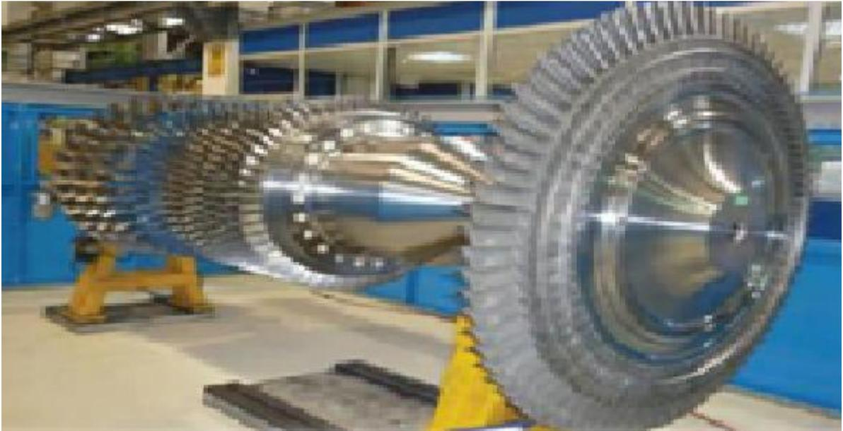
a-Rotor de la Turbine Haute Pression
