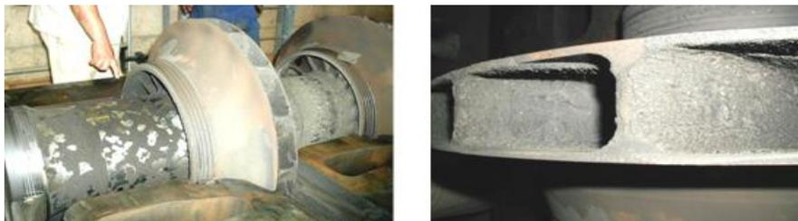
*fig 6.11 Arbre et roues encrassées*
