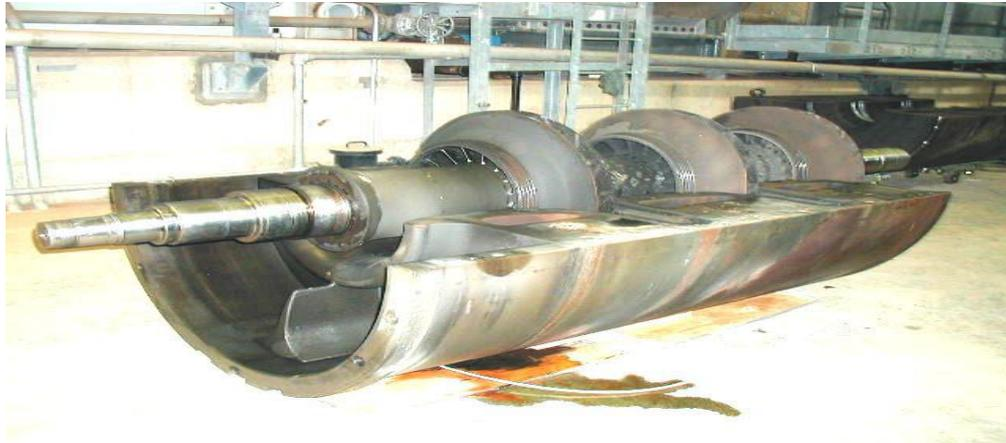
*fig 6.10 Rotor après le démontage*
