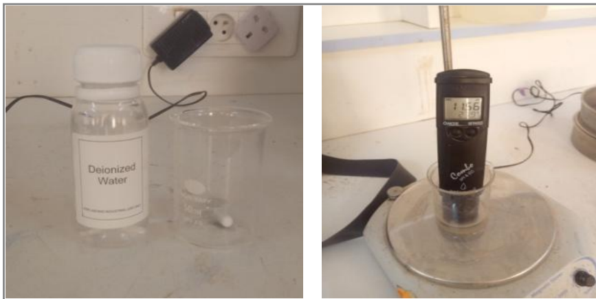
Figure III. 25. Mesure du pH d'une poudre du mortier.
