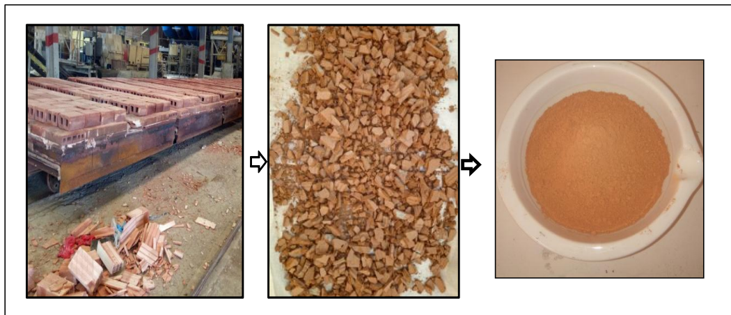
Figure III.11. Etapes de la préparation de la poudre de brique (PB).
