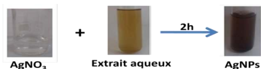
Figure 21 : Schéma illustrant le protocole de formation des nanoparticules d'argent.
