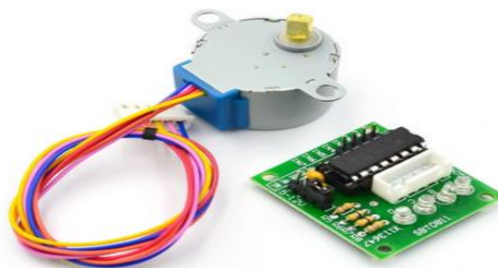
Figure 7 - Moteur Pas à Pas 28BYJ-48 et le Pilot ULN2003
