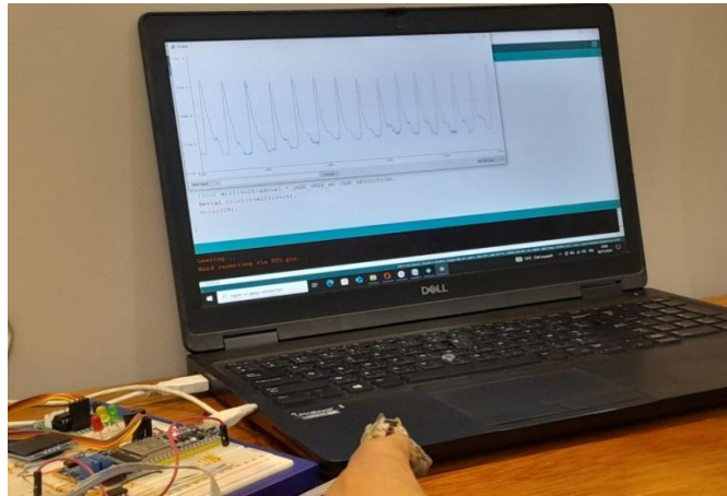
Figure III.5 - Visualisation du signal PPG sur IDE Arduino
