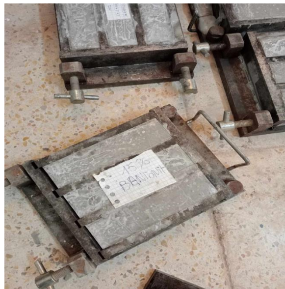
Fig. II-7. Moules d'éprouvettes prismatiques ( 4 \times 4 \times 16 ) \text{cm}^3
