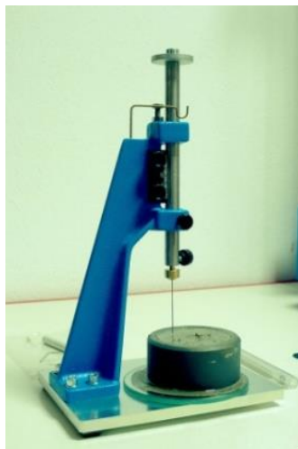
Fig. II-12. Appareil de VICAT muni d'une aiguille pour la mesure du temps de prise
