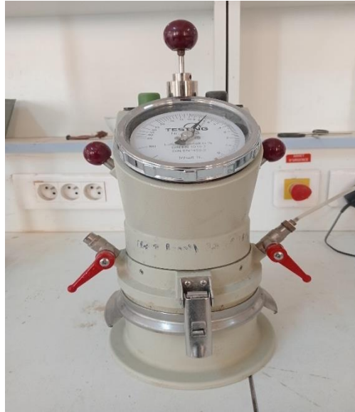
Fig. II-10. Dispositif de mesure de la teneur en air occlus (aëromètre) (Labo. de G. Civil - Univ. d'Ain Témouchent)
