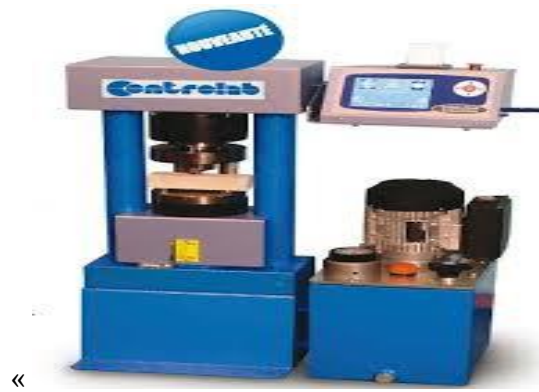
Fig. II-16. Ecrasement des éprouvettes (40x40x160) cm 3 à l'aide d'une presse hydraulique de 250KN (Lab. de G. civil-UAT)
