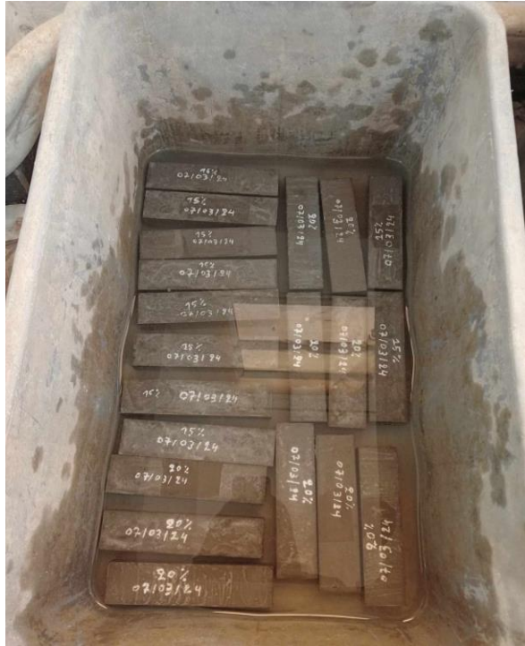
Fig. II-8. Conservation des éprouvettes dans l'eau à 20 \pm 2 °C selon la norme NF P 15-402
