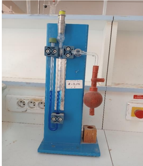
Fig. II-5. Perméabilimètre Blaine (Labo. de G. Civil - Univ. d'Ain Témouchent)
