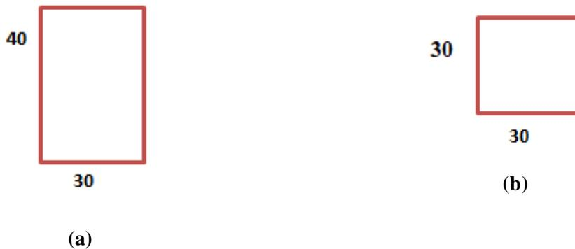
*Figure I.2 :section de la poutre principale (a) et de la poutre secondaire (b)*
