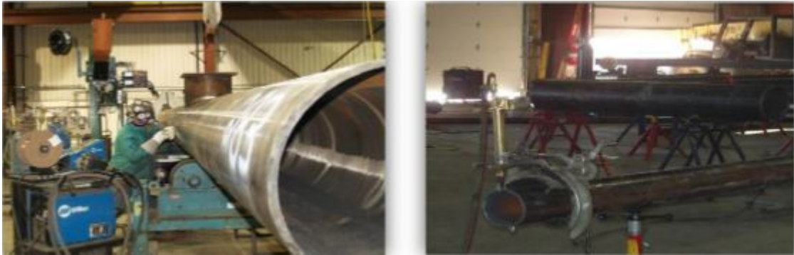
Figure I.9 : Soudage manuel et automatique des tubes. [9]
