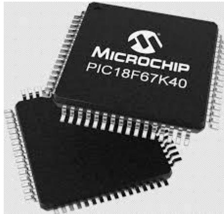
Figure 15 : microcontrôleur pic 18F67K40
