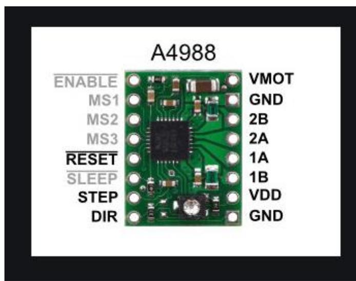
Figure 22 : broches d'un driver a4988
