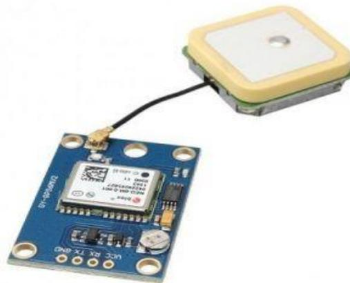
Fig. II.2. Module GPS NEO 6M [W17]
