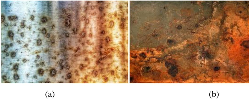
Figure II.3: Corrosion localisée (a) corrosion généralisée (b).
