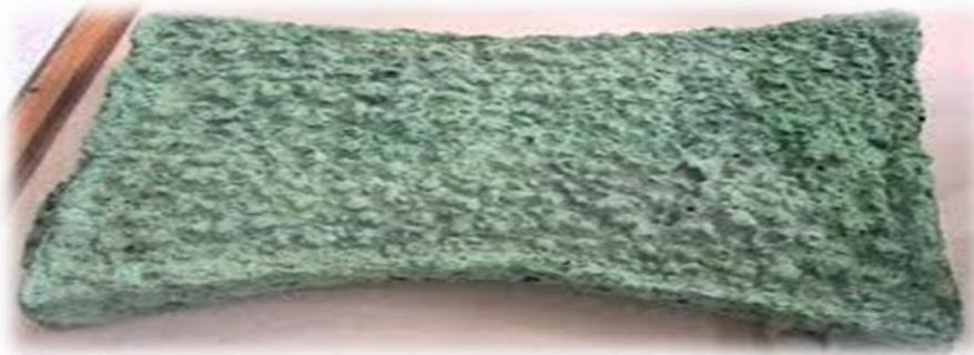
Figure II.1 : corrosion du cuivre
