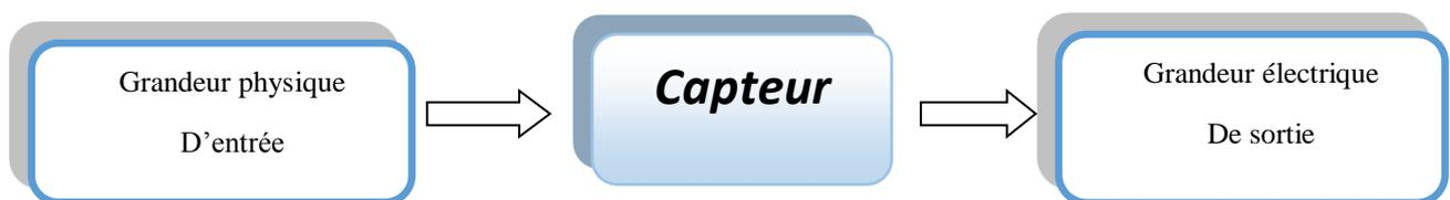
**Figure I.1** : Principe de fonctionnement d'un capteur
