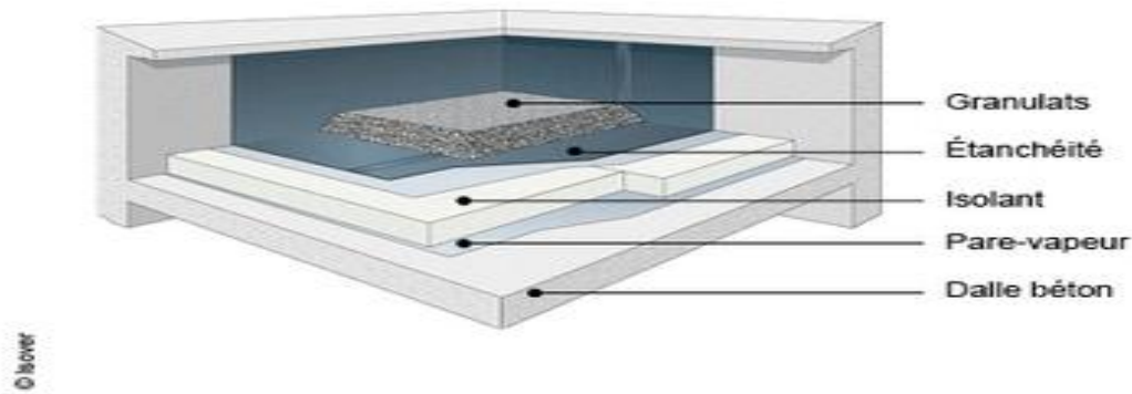
Figure III – 7 ; Plancher terrasse inaccessible
