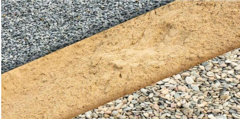
Figure I-2: différents types de granulats utilisés dans un béton . [17]
