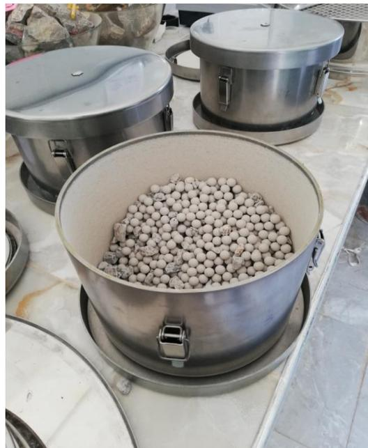
Figure II-25 : les jarres de l'essai micro deval.
