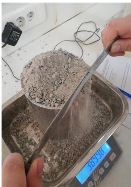
Figure II-17: masse volumique apparente du sable de carrière.
