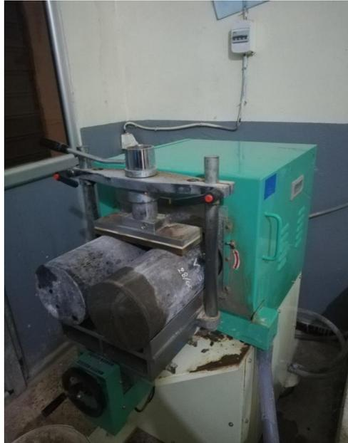
Figure II-32: surfaçage des éprouvettes.
