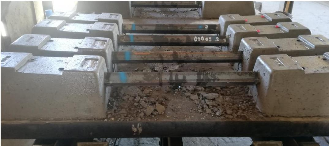
Figure IV-43: la traverse réalisée à partir de nos formulations étudiées.
