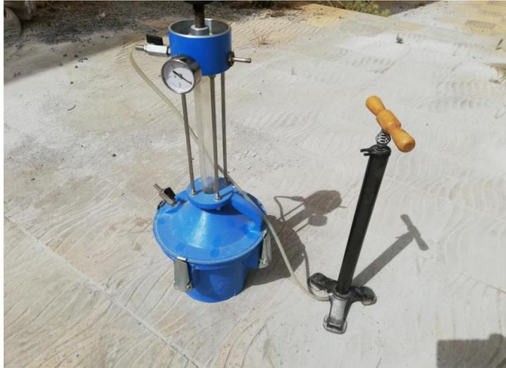
Figure II-27: essai de la teneur en air.
