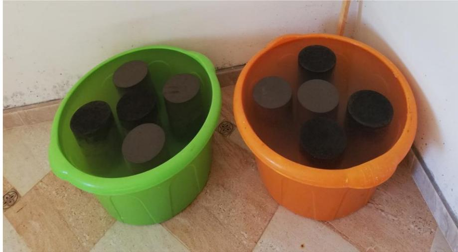
Figure II-29: la conservation des éprouvettes dans l'eau ( 7 et 28 jours).
