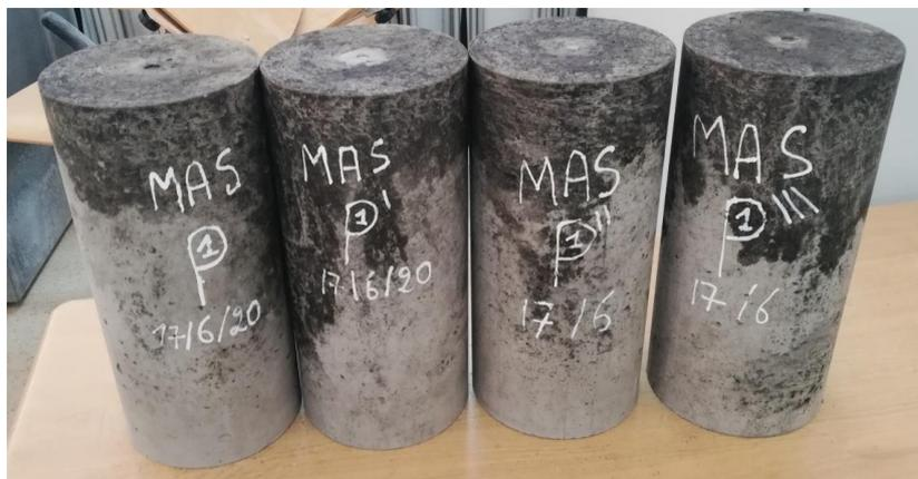
Figure II-30: mesure de la masse volumique du béton durci après démoulage.
