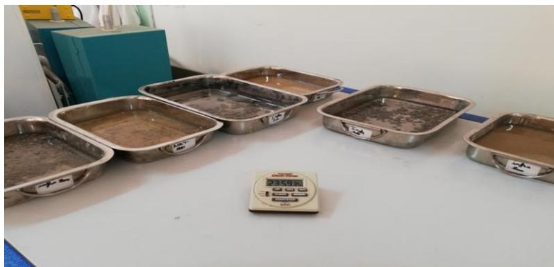
Figure II-19: essai d'absorption d'eau.
