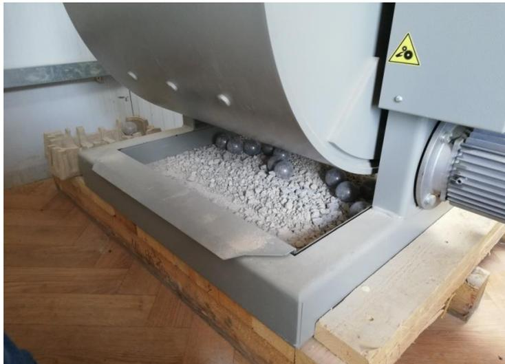
Figure II-24: la machine de Los Angeles.
