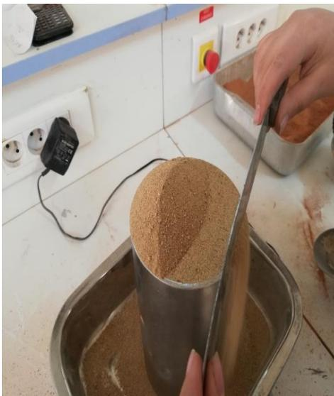
Figure II-16: masse volumique apparente du sable roulé.
