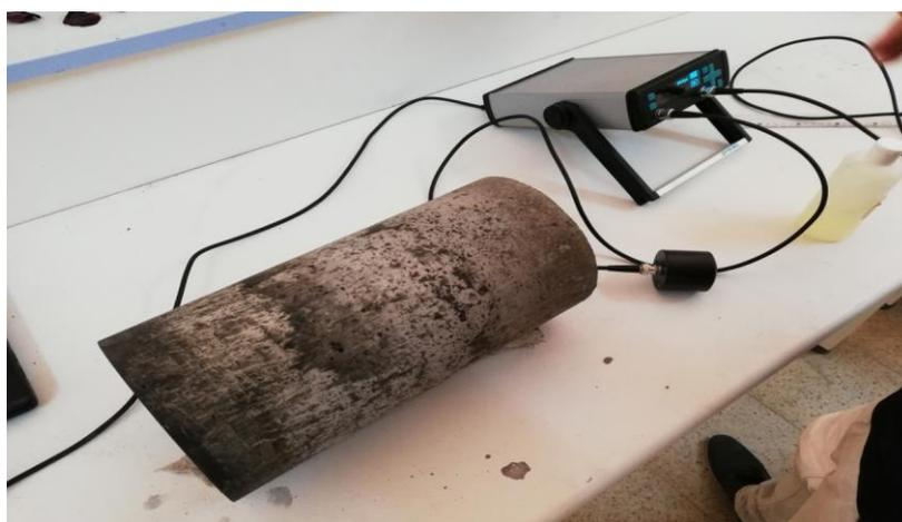
Figure II-33: mesure de la vitesse de propagation du son.
