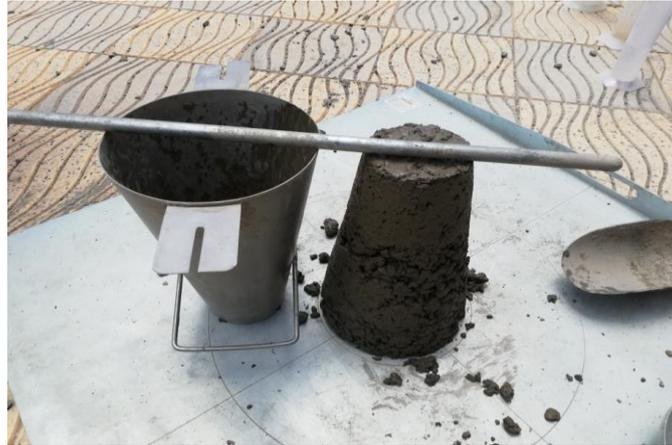
Figure II-26: l'essai d'affaissement.
