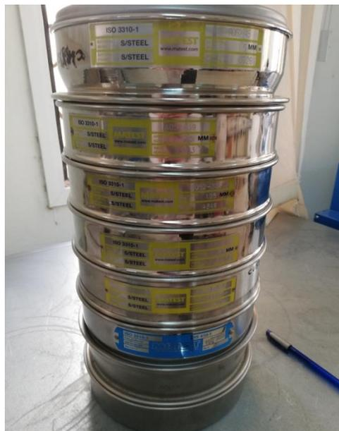
Figure II-14: la série des tamis utilisé pour l'analyse granulométrique.
