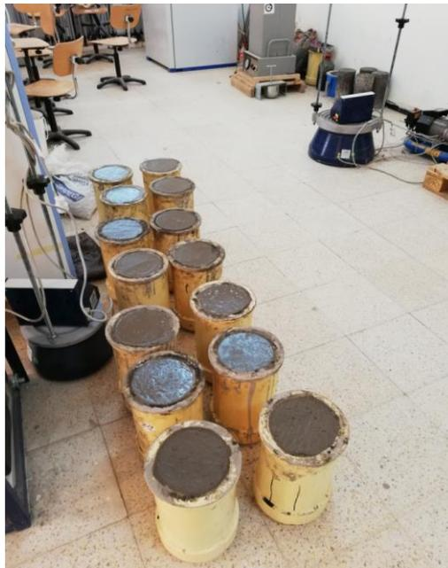
Figure II-28: la conservation des éprouvettes pendant 24 h au laboratoire.
