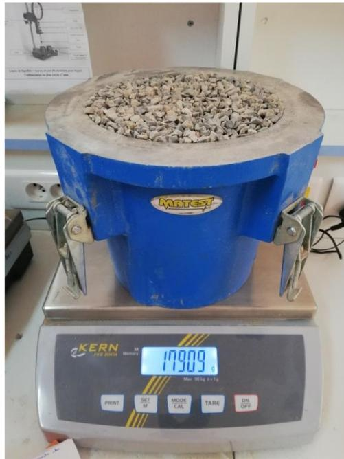
Figure II-18: masse volumique apparente du gravier.
