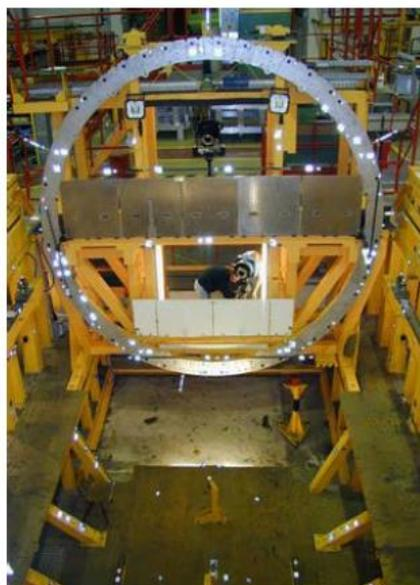
a) Contrôle périodique d'un gabarit d'outillage à l'aide Rollei LFC et GSI CRC-1 caméras film
