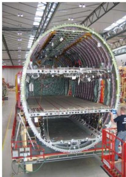
b) Mesure de l'interface du fuselage de l'A380 avec la caméra numérique métrique GSI INCA
