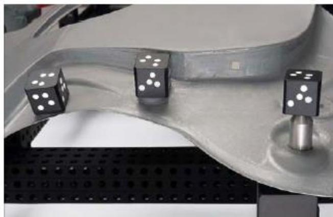
**Figure 37 : Cubes d'adaptateur AICON. [12]**
