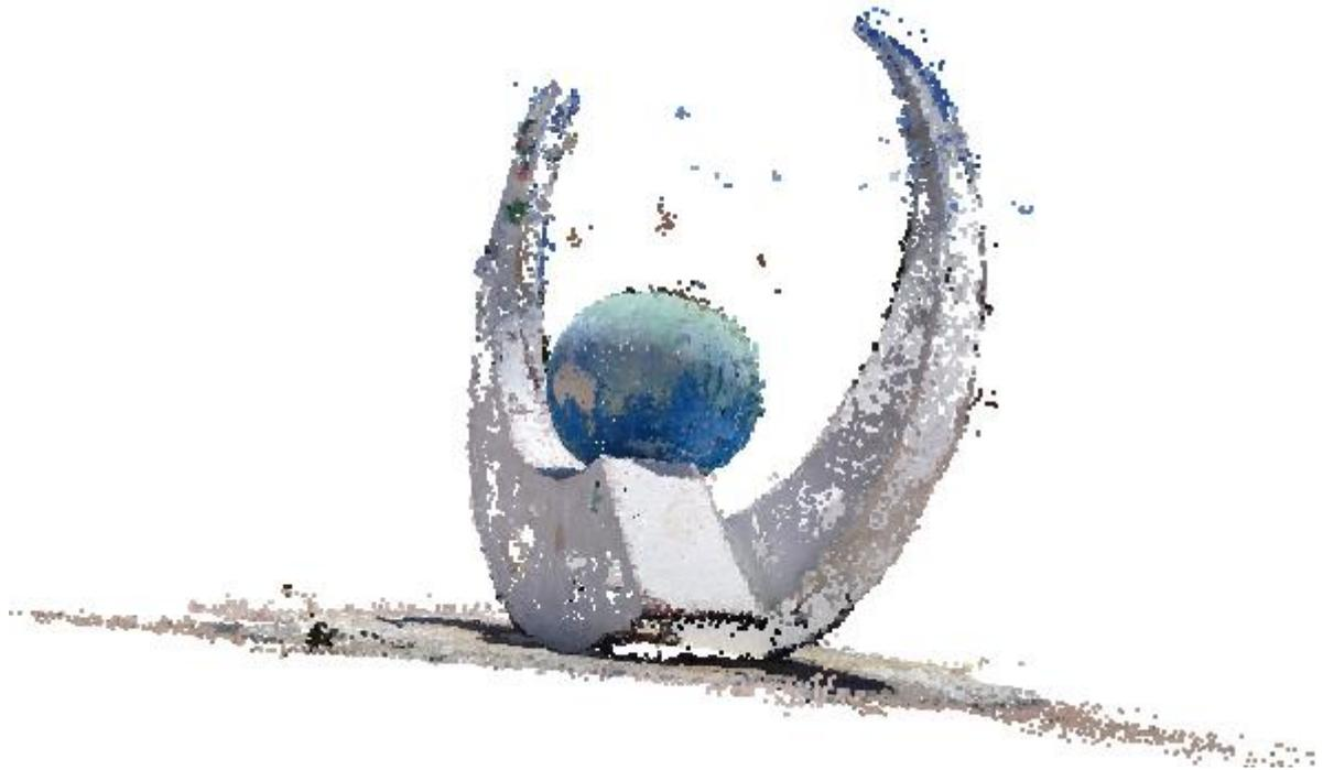
**Figure 183 : résultat de nuage de point densifier**
