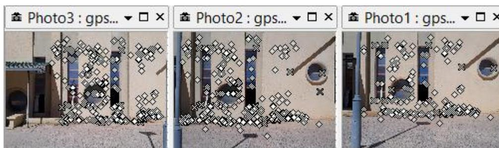
**Figure 173 : les résultats de liaison des points de calage détecter automatiquement**
