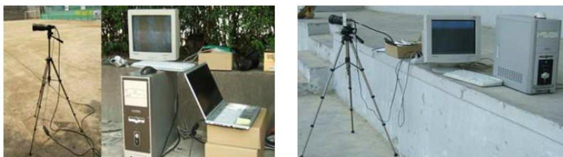
**Figure 159 : Vue des caméras CCD et du système informatique avec VMS. [51]**
