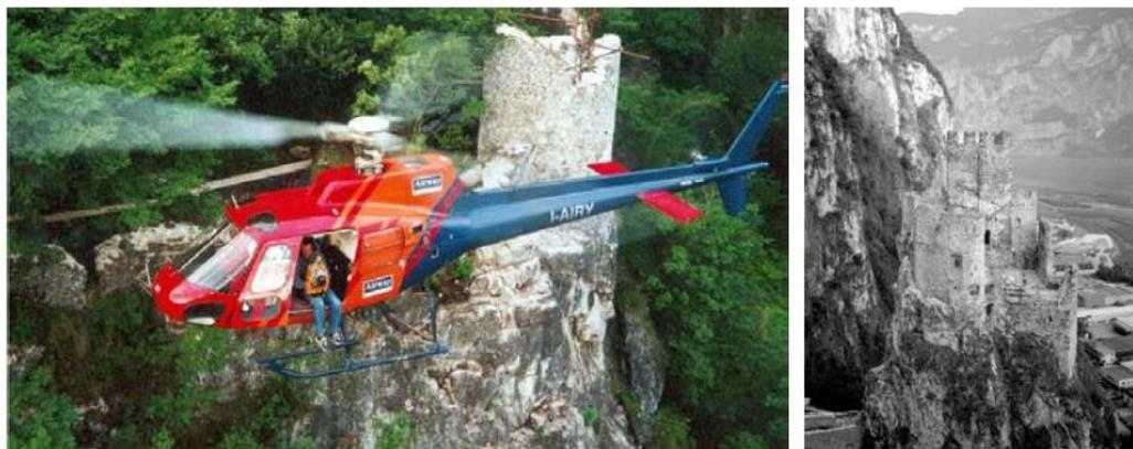
**Figure 91 : Enregistrement d'images par hélicoptère à l'aide d'une caméra métrique UMK. [12]**
