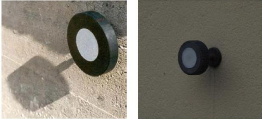
**Figure 31 : Exemples de cibles circulaires artificielles. [12]**
