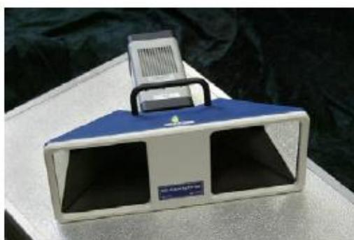
Figure 72 : Caméra haute vitesse avec fixation de miroir stéréo (HS Vision).
