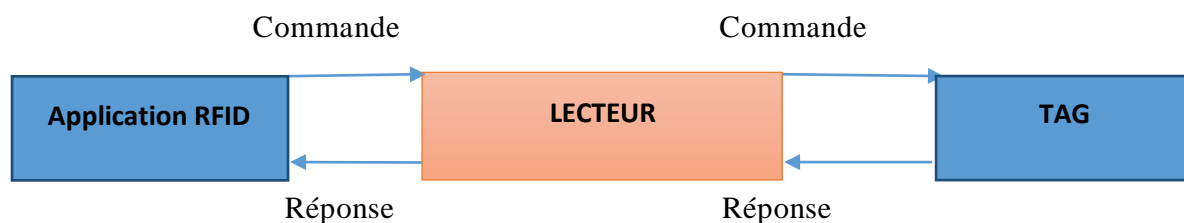
Figure 2. 10 : Relation maître-esclave dans la communication RFID.[25]
