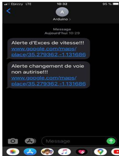
Figure III.3 : Capture de la réception du SMS.
