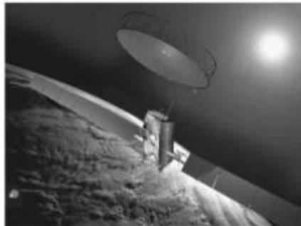
**Figure II. 6:** Antenne à réflecteur (AstroMesh) d'INMARSAT-4
