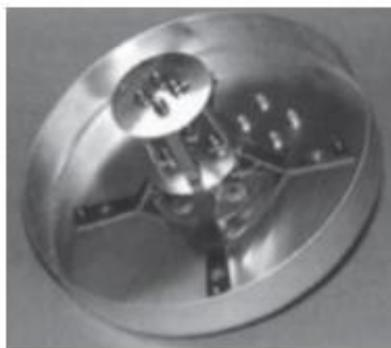
**Figure II. 4:**Antenne bande X par RUAG [26]
