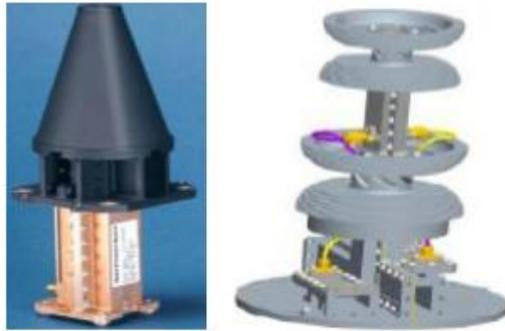
**Figure II. 3:** Antenne de télémétrie, poursuite et de commande
