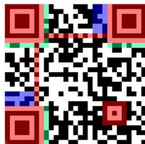
Figure 10 : Modules de code QR
