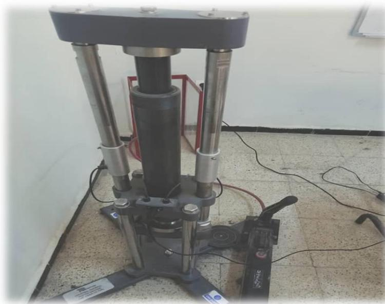
**Figure 2.17.** Dispositif de compression pour mortier
