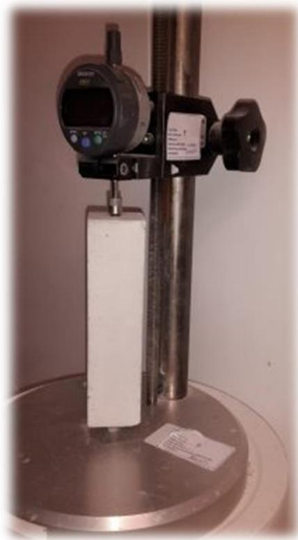
**Figure 1.4. retractomètre**
