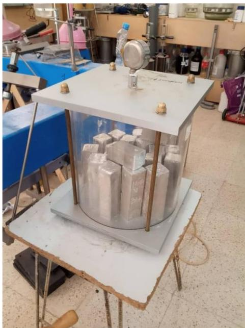
Figure 2.18. Dispositif pour la carbonatation accélérée.
