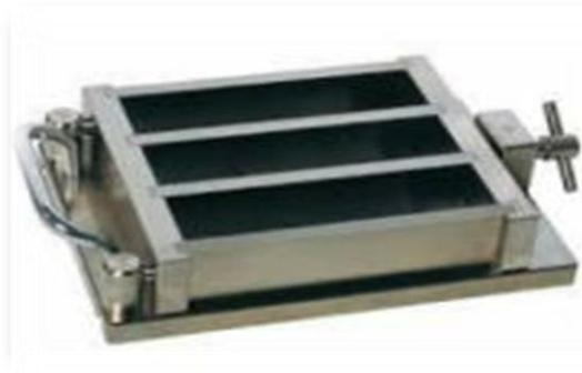
**Figure 2.11.** Eprouvette prismatique (4\*4\*16)
