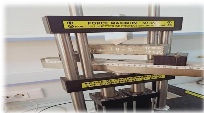
**Figure 2.15.** Appareil de l'essai de flexion
