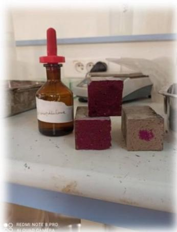
Figure 2.19. Test à la phénolphtaléine et mesure du front de carbonatation.
