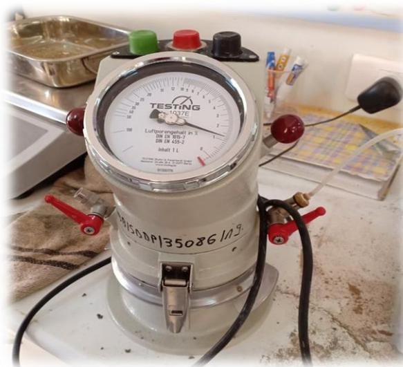
**Figure 2.14.** Appareil de mesure de teneur en air occlus Essai sur mortier durci .
