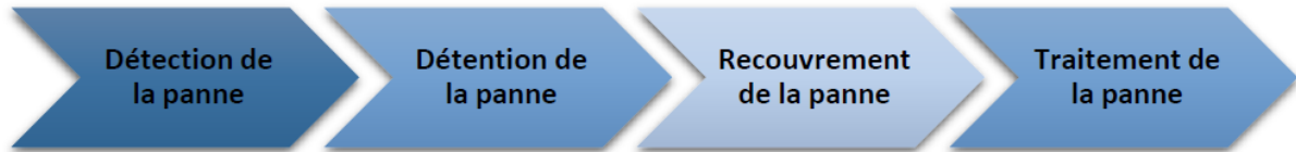
Figure II.2 : Procédure générale de tolérance aux pannes.
