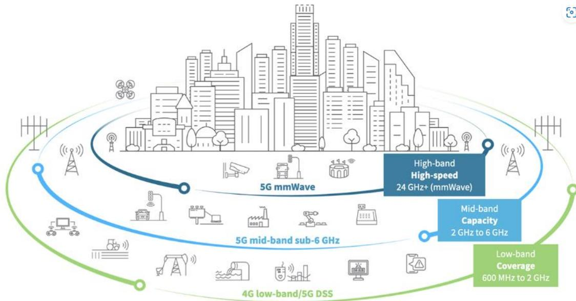
**Figure II. 2: Les bandes de fréquences 5G [28]**
