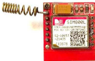
**Figure II.5 : Module GSM (SIM800L).**
