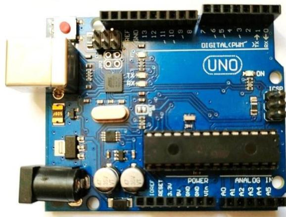
**Figure II.2 : ARDUINO (UNO).**
