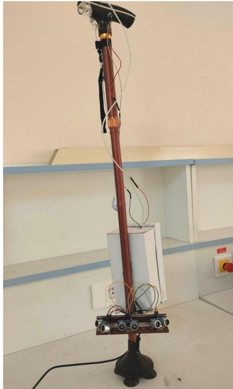
**Figure III.1: Notre réalisation canne intelligente pour les non-voyants.**
