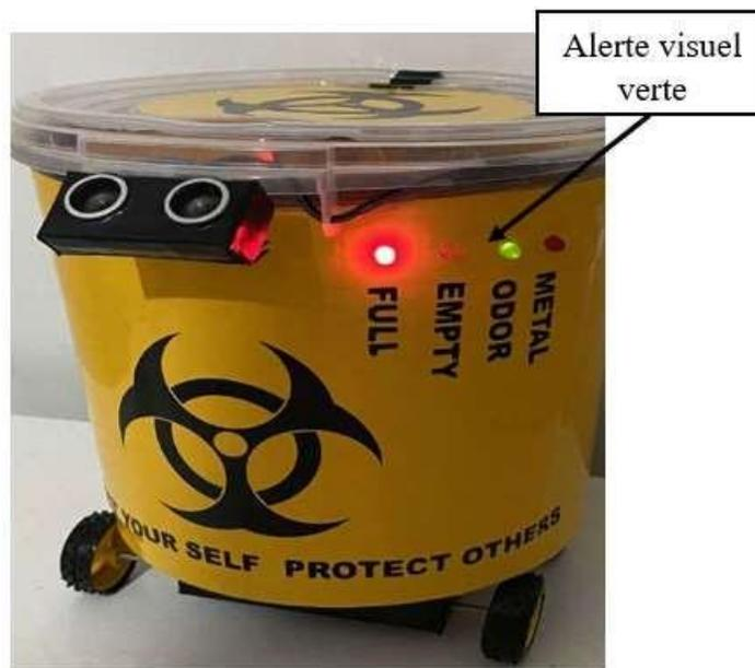
Figure III.12: détection des mauvaises odeurs.
