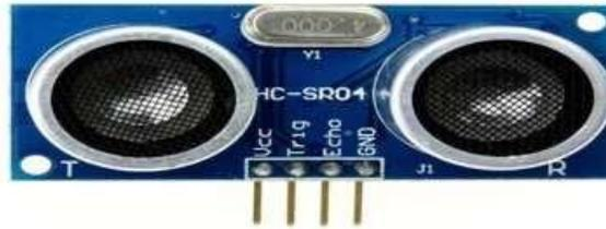
Figure II.2 : Capteur ultrason HC-SR04.
