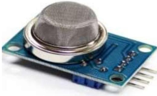
**Figure II.3 :** Capteur de gaz MQ2.
