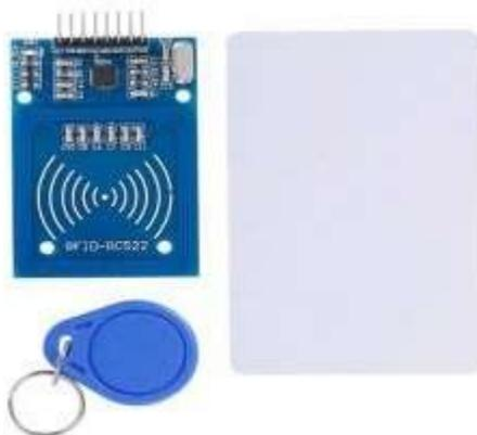
**Figure II.4 :** Module RFID RC522.
