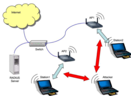
FIG. 1.6 : Un scénario générique d'attaque DoS sur un réseau 802.11. [Kemal et Bulent, 2009].
