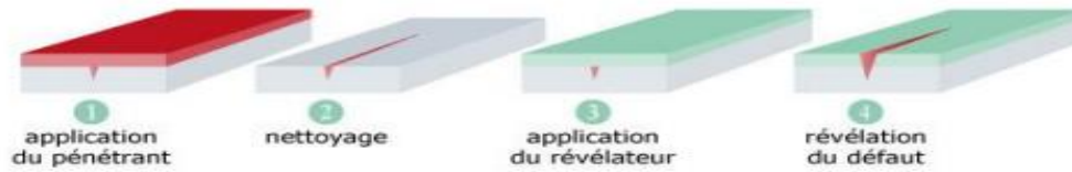
Figure I . 11: Opérations d’application pénétrant-révélateur [22].
