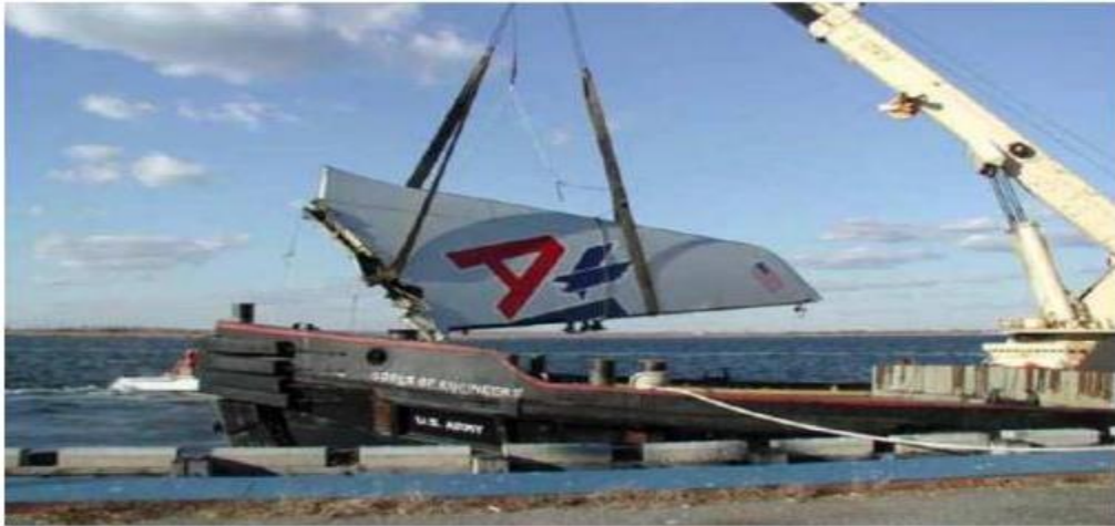
Figure II. 1: Stabilisateur vertical, qui s'est séparée du vol American Airlines 587 [Un accident mortel][29].
