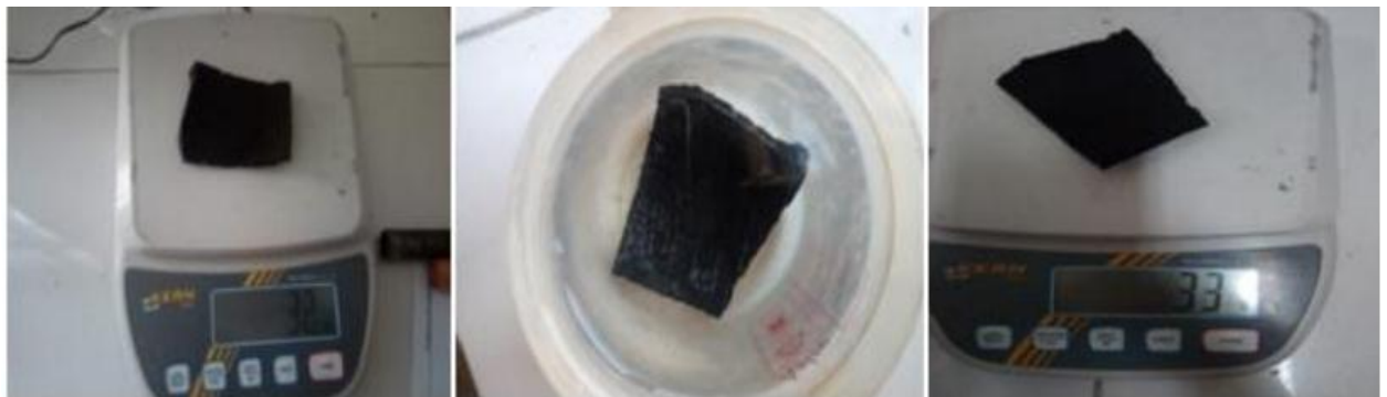
Figure II.2: avant et après l'absorption de l'eau par le caoutchouc
