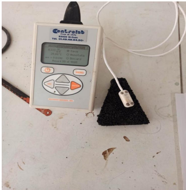
Figure II.7: La mesure de la conductivité thermique
