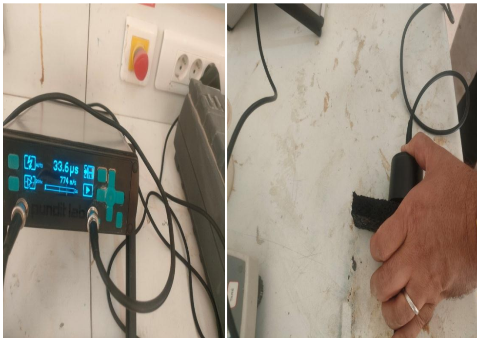
Figure II.5: Mesure de la vitesse de propagation de son
