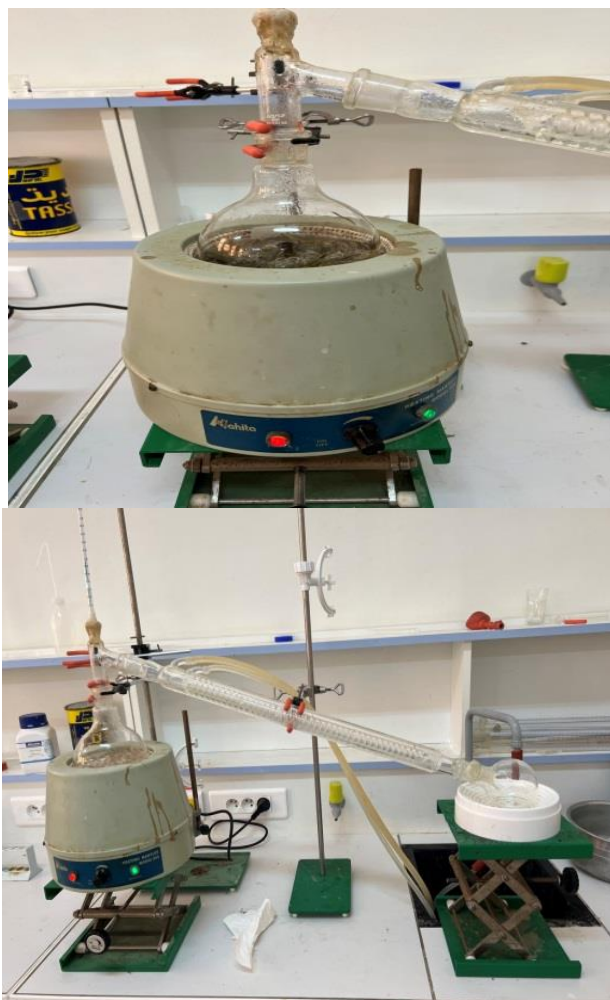
Figure -III.2 : Montage d'hydro distillation de romarin
