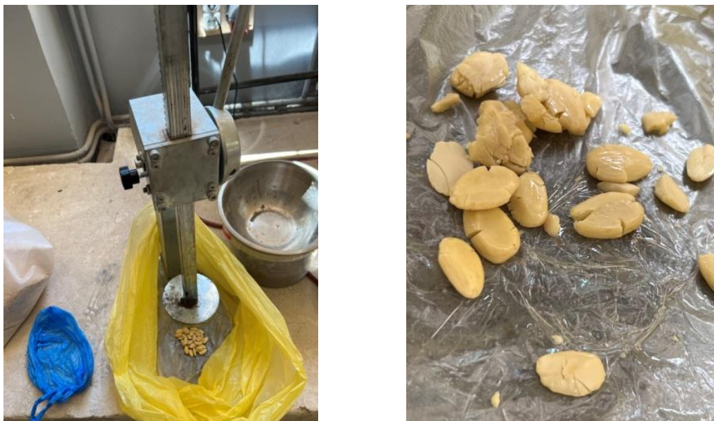
Figure-III. 4 : Expression mécanique à froid d'amande
