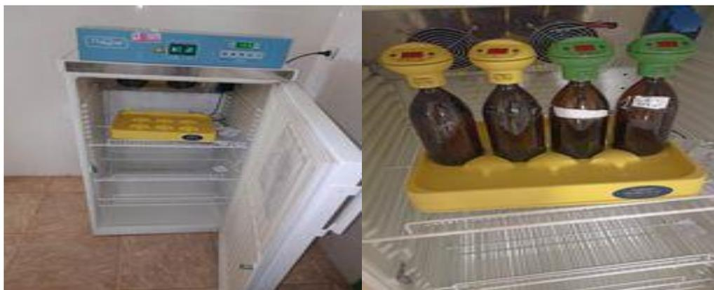
**Figure N°30 : incubateur DBO (2023).**
