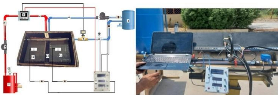
1- Réservoir d'eau froide 2- Réservoir d'eau chaude 3- Mesure de pression 4- Conduite d'eau froide 5- Régulateur de température intelligent 6- Capteur de température 7- Capteur de débit à sortie analogique 8- Système d'unité de contrôle électronique 9- Débitmètre de vitesse 10- Débitmètre massique 11- Échangeur de chaleur 12- Conduite d'eau chaude 13- Boîtier de commande.
