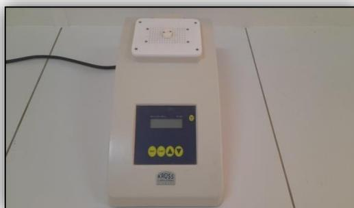
**Figure B.1 :** *Appareil KRUSS de point de fusion*
