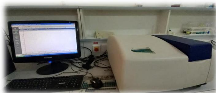
**Figure B.2 :** *Spectrophotométrie d'absorption moléculaire UV-visible*
