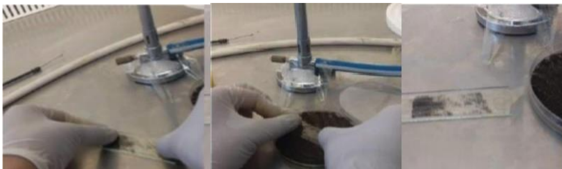
Figure 6 : Méthode de préparation de frottis pour l'observation microscopique des moisissures par la technique de scotch.
