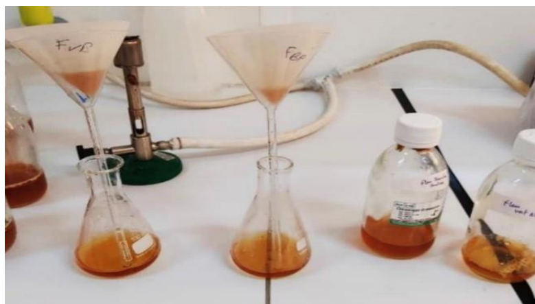
Figure 7: Méthode de filtration de milieu YES par papier Wattman.
