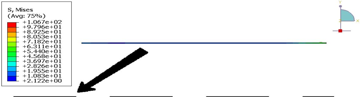
Figure 37: Contraintes V.Mises de AlCu du modèle Si0.4-SAC105
