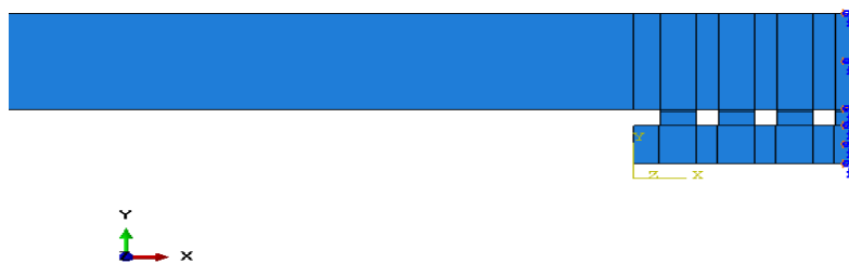
Figure 17: Conditions aux limites (symétrie)
