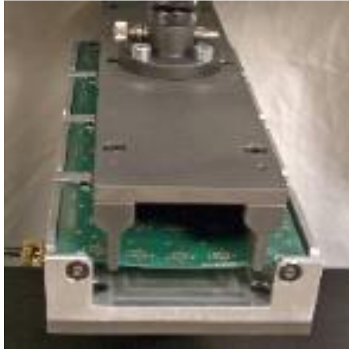
Figure 9: Essai de flexion quatre point sur des circuits imprimés PCB comportant des microcomposants électroniques 3 .
