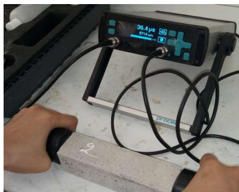
Figure II.16 : Mesure de la vitesse de propagation de son.
