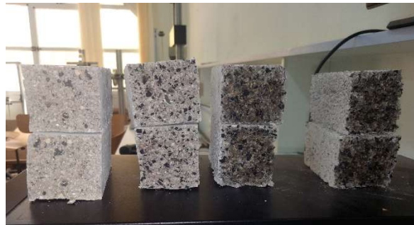
Figure II.10 : La rupture des éprouvettes de 14 jours par essai de flexion.
