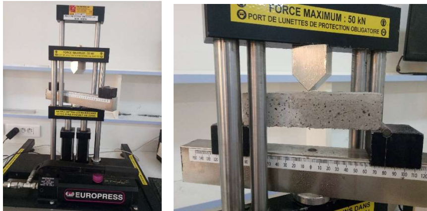
Figure II.9 : Dispositif de l'essai de flexion.
