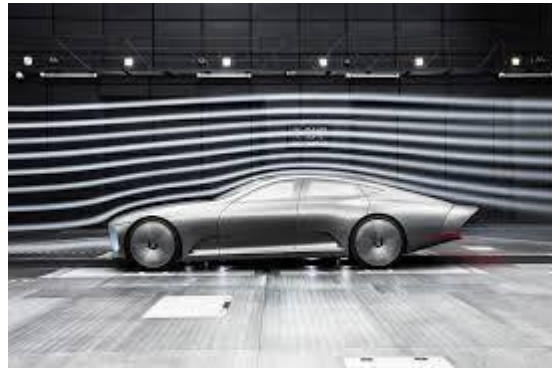
Figure 13 :Maquette automobile dans une veine d'essai de soufflerie
