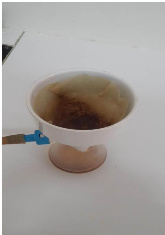
**Figure II .3 :** Filtration sous vide de l'huile de friture usée.
