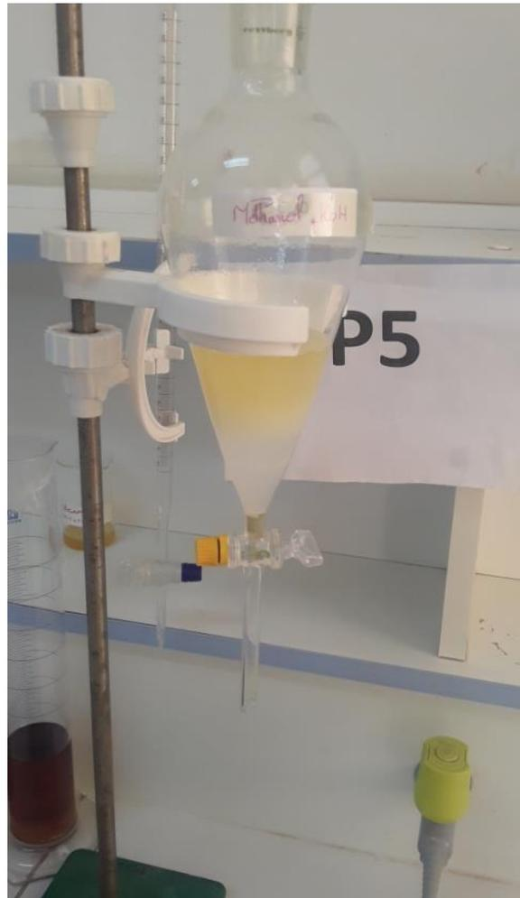
Figure II.6 : Lavage de biodiesel.
